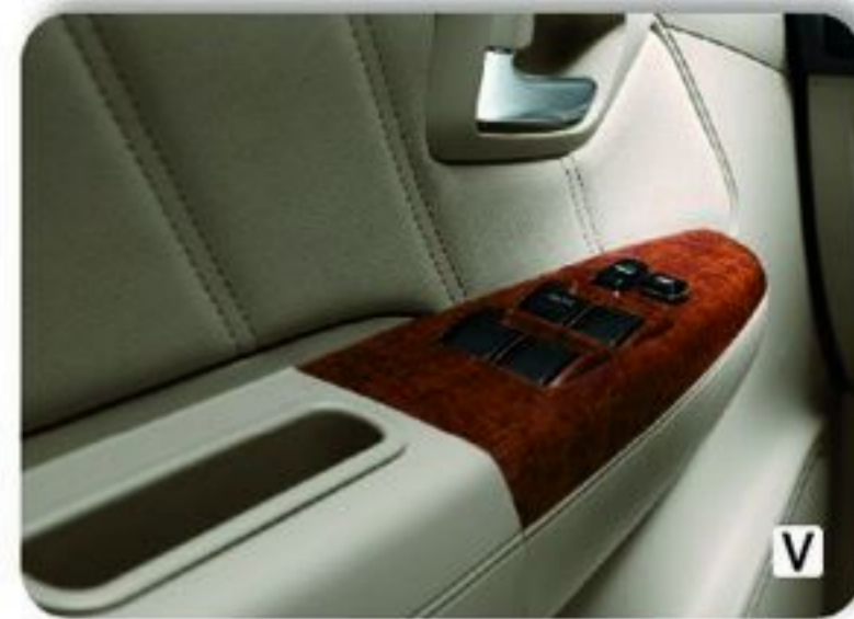
Các nút điều khiển phía người lái cho phép người lái hạ kính và điều chỉnh tất cả cửa sổ một cách linh hoạt và dễ dàng.
